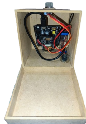
Figura 6. Armado del circuito interno del primer sensor. Fuente: Elaboración propia.
