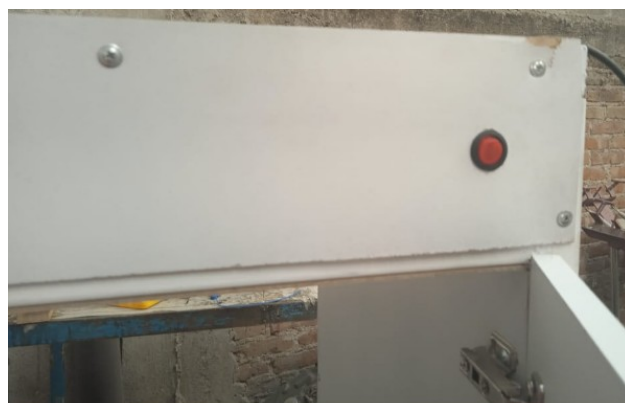
Figura 11: Botón de encendido y apagado del sistema. Fuente: Elaboración propia.
