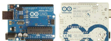
Figura 1: Frontal y reverso de la placa Arduino TM Uno. Fuente: (Lledó Sánchez, 2012).
