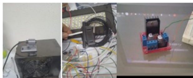
Figura 7: Laser, micro interruptor y modulo L298n utilizados en el sistema de iluminación. Fuente: Elaboración propia.
