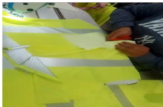
Figura 5: Forma de la plaqueta con tijeras de manera manual. Fuente: Elaboración propia.
