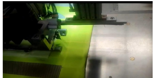
Figura 10: Prensado de la tela y corte de navaja. Fuente: Elaboración propia.
