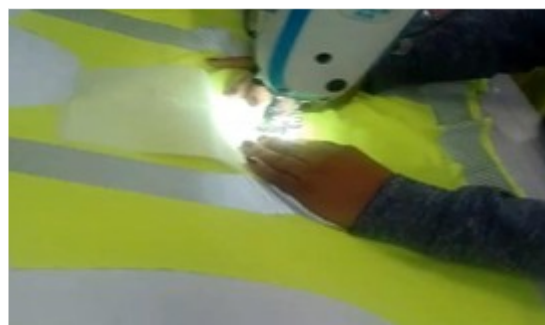
Figura 3: Coser para formar la plaquet con la maquina manual. Fuente: Elaboración propia.
