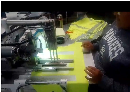
Figura 6: Acomodo de pieza en la máquina de coser multifuncional automática. Fuente: Elaboración propia.
