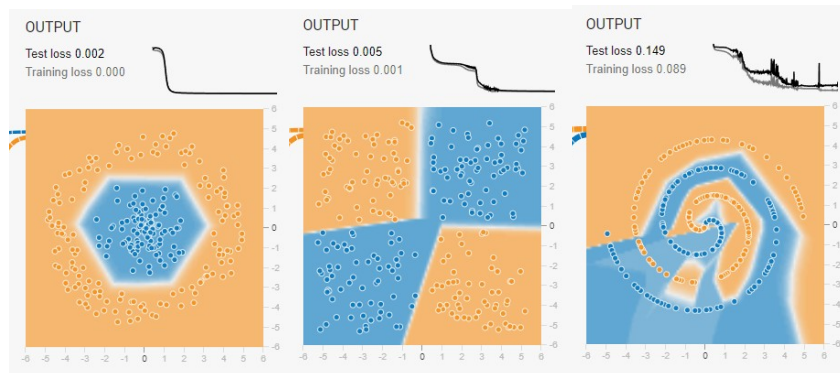
Figura 4. Muestras del entrenamiento con más capas ocultas y la función de activación ReLU. Fuente: Elaboración propia.
