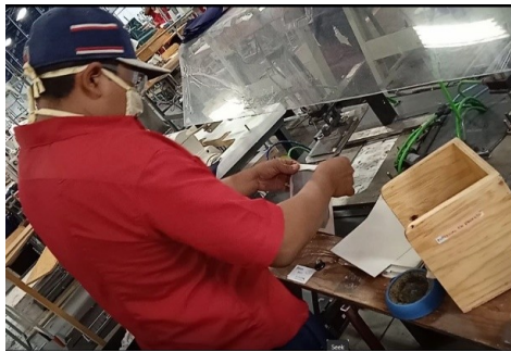
Figura 4. Plancha Semiautomática, requiere activación manual. Fuente: Elaboración propia.
